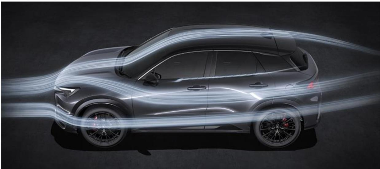
**À l'arrière, des ailettes verticales sont utilisées pour rediriger le flux d'air depuis les côtés du pare-chocs,** garantissant un flux stable sans turbulence et diminuant la résistance de l'air. Un cache moteur doté de conduits NACA\*\* a été intégré au soubassement. Ces prises d'air contribuent au refroidissement de la boîte de transfert, permettant une conduite prolongée du circuit.
