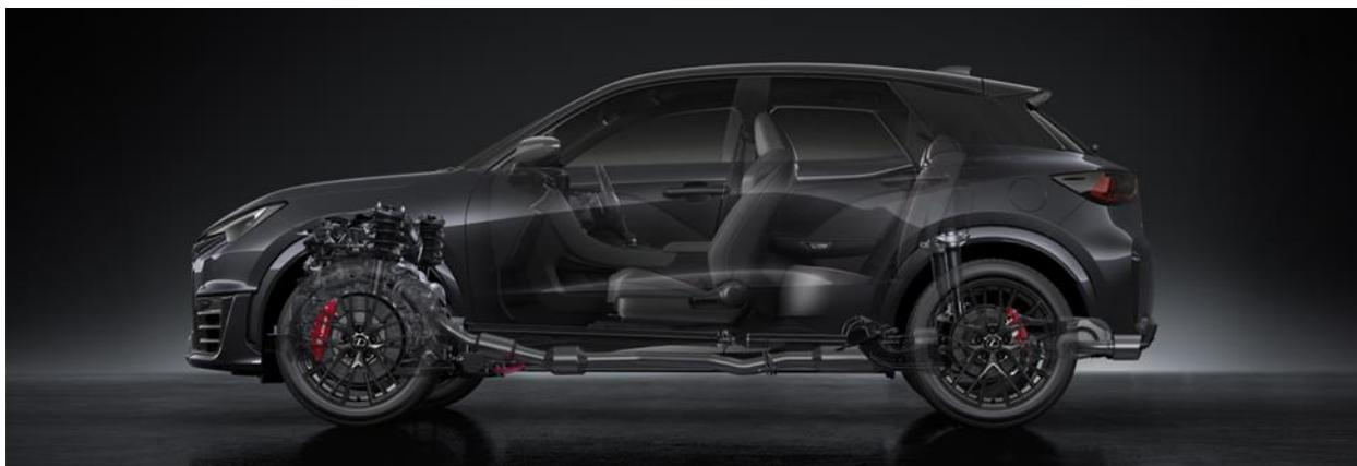
Pour accueillir le puissant groupe motopropulseur, la plateforme TNGA (GA-B) a été optimisée pour adapter les éléments spécifiques à ce modèle : différentiel, suspension et transmission intégrale.
