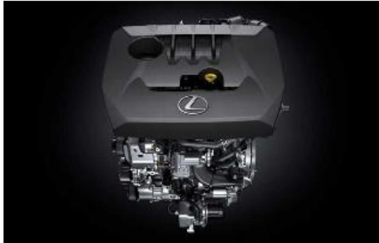
**Une combustion à grande vitesse est obtenue** grâce à l'utilisation d'orifices d'admission à haut rendement et à haute efficacité, ainsi que d'injecteurs directs de carburant à orifice multi-trous, offrant un équilibre entre une puissance de sortie accrue et une prévention efficace des détonations. De plus, le positionnement du convertisseur catalytique directement sous le turbocompresseur améliore considérablement les capacités de purification en nettoyant les gaz d'échappement.
