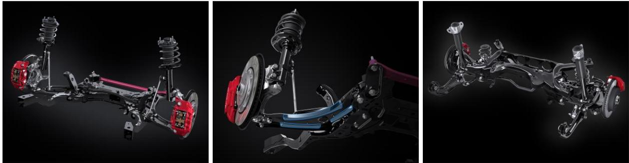
**Le système de freinage est conçu pour un refroidissement optimal.** Le modèle à boîte automatique reçoit des disques ventilés de 18 pouces à l'avant et des disques pleins de 16 pouces à l'arrière. Le modèle à boîte manuelle est lui équipé de disques ventilés à l'avant et à l'arrière. Le réglage des freins met l'accent sur la rigidité de la pédale, offrant ainsi une sensation de freinage idéale, adaptée à la conduite sportive.
