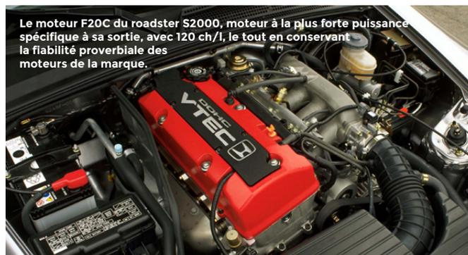
Le moteur F20C du roadster S2000, moteur à la plus forte puissance spécifique à sa sortie, avec 120 ch/l, le tout en conservant la fiabilité proverbiale des moteurs de la marque.
